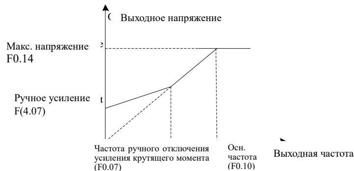
Рис.6-10 Схема усиления крутящего момента
