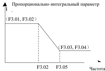
Рис. 6-7 Схема пропорционально-интегральных параметров контура скорости
