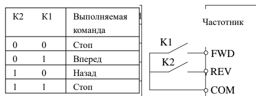
Рис.6-13 Двухпроводной режим управления 1
