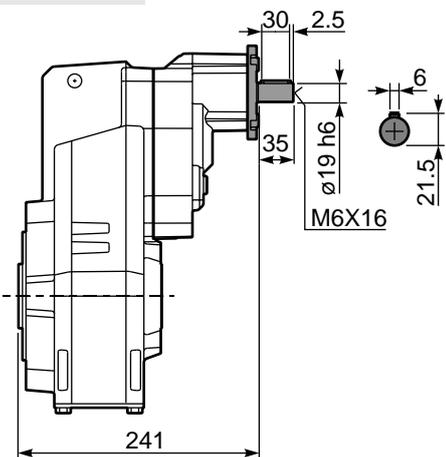
**PFC73 A...** Односторонний выходной вал
